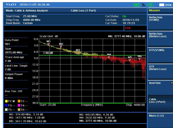
ケーブル・アンテナテスト - ケーブルロス
